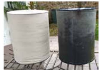
CARTOUCHE DE FILTRATION 0.5 MICRON AVANT / APRÈS 20 000 KM MONTAGE APRÈS FILTRATION CONSTRUCTEUR
