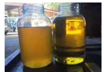
CAZOLE FON DE CUVE STATION SERVICE AVANT / APRÈS FILTRATION
